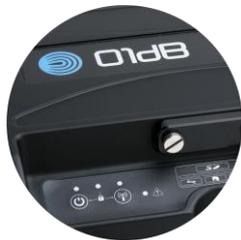
Afin d'augmenter sa résistance aux contraintes extérieures, ORION est dépourvue d'écran. Un clavier simplifié à 2 touches permet de démarrer la station et de mettre en fonctionnement le Wi-Fi. Plusieurs leds renseignent sur l'état d'ORION : Mesure en cours, Wi-Fi opérationnel, Communication 3G, Etat de la batterie...
