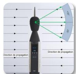
entwickelt wurde, bei denen sich Geräuschquellen rund um das Gerät befinden können, und zwar insbesondere aus der horizontalen Richtung. Die Außenmikrofoneinheit DMK01 ist in FUSION für eine Ausbreitungsrichtung konfiguriert, die um 90° von ihrer Achse abweicht, um die Anforderungen der Norm IEC 61672 für Schallpegelmessgeräten in Bezug auf den Geräuscheinfall aus horizontaler Richtung perfekt zu erfüllen.
